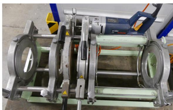
Spiegelschweissmaschine bis 250 mm
